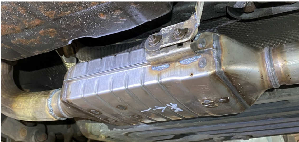
Eksempel 2) Montering på højre side af gearkasse. Her MB E270 2,7 CDI EURO 3, med split forrør til 2 rør med lydpotte. Dette kræver modificering af beslag til ophæng på gearkasse, og modificering af bundplade.
